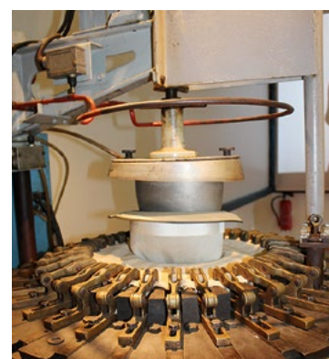
Mit dieser Maschine wurden die Hüte in Form gebracht.
